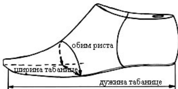
Слика 1 – Основне димензије калупа ЦВУ за МнОп
